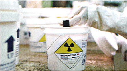
ஈய கவசப்பெட்டியில் அயோடின் 131 கேப்கூல் பாதுகாப்பாக வைக்கப்பட்டு இடமாற்றம் செய்யப்படுதல்
